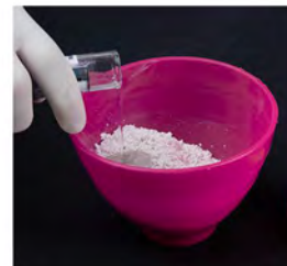
Paso 02 Vierta la medida en polvo (10 g) y, a continuación, añada el agua (19 mL)
